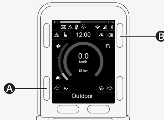
Se il Bluetooth è abilitato su più di un dispositivo Bluetooth associato, sullo schermo compare un elenco di dispositivi associati. Per collegare e utilizzare un dispositivo associato, selezionare l'ID del dispositivo e spostare il joystick a destra.
